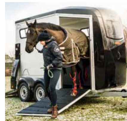
Wide, extra-long front unloading hatch with rubber coating and "gas spring" lifting device Bred og ekstra lang losselem med gummibelegg og løfteinnretning "Støtdemper"
